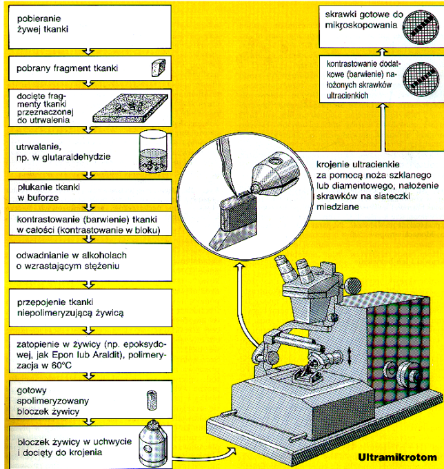
Ryc. 2. Schemat blokowy następujących po sobie etapów preparatyki, koniecznych aby ze świeżo pobranej tkanki uzyskać ultracienkie skrawki (grubości 50 nm) ostatecznie przygotowane do mikroskopii elektronowej.
