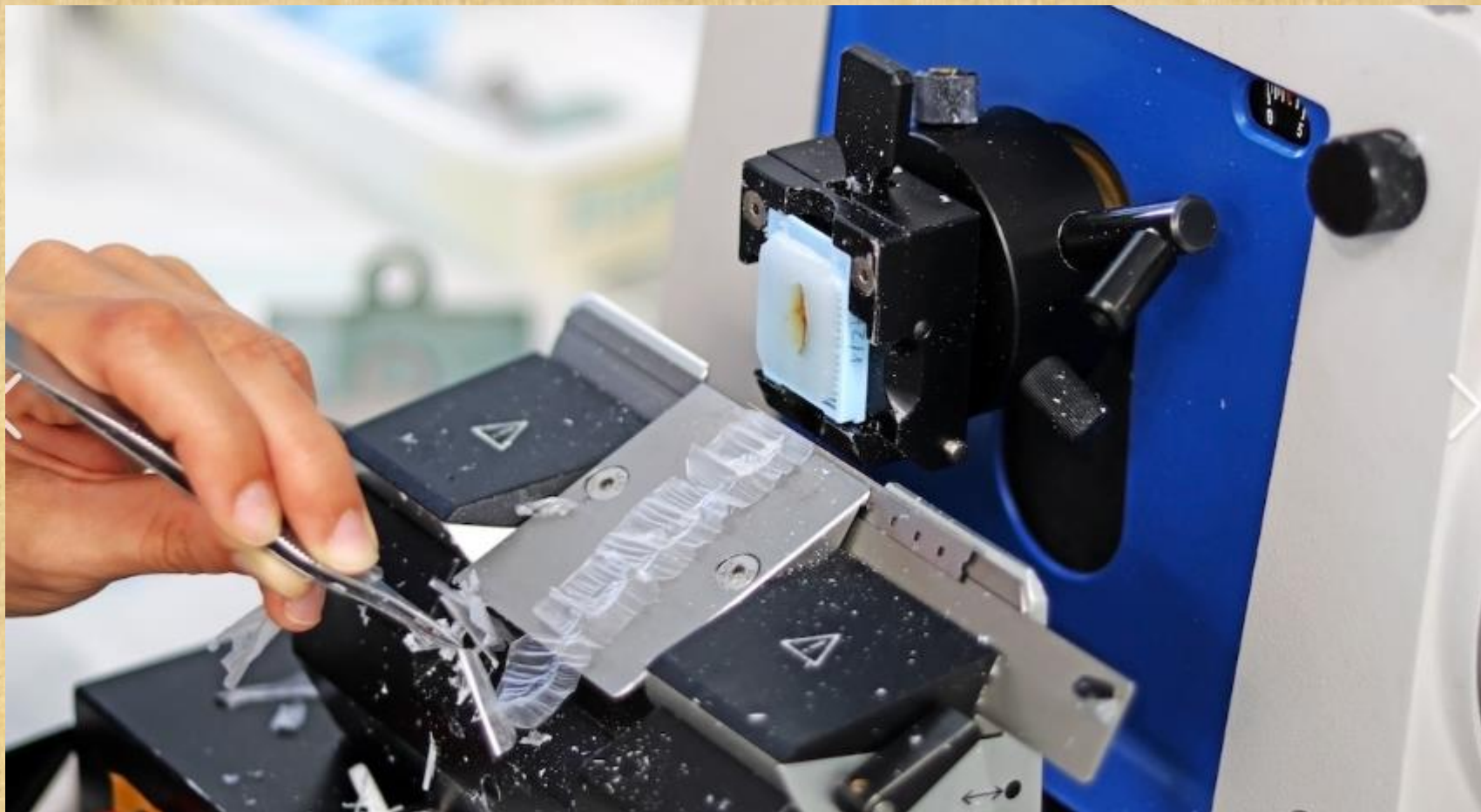
Krojenie bloczków na mikrotomie
