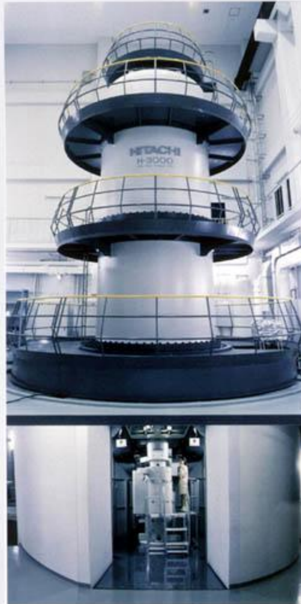
Model : H-3000 Height : 13.5 m Weight : 140 tons
